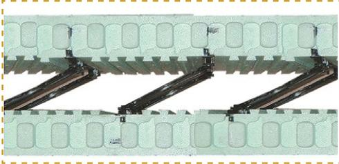
Gros plan du treillis métallique à articulation pliante
