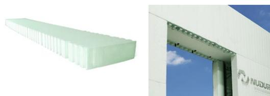
La capsule isolante pour linteau ou cavité permet aux installateurs d'isoler le haut et le bas des ouvertures pour minimiser les ponts thermiques. Les capsules ont une épaisseur de 2" (50mm).
