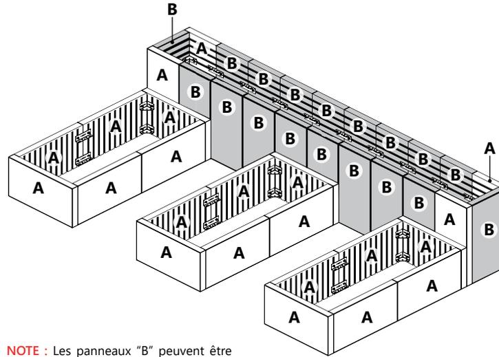
**NOTE :** Les panneaux "B" peuvent être remplacés par des panneaux "A" pour équilibrer les paires/rangs. Les panneaux "A" ne peuvent pas être remplacés par les panneaux "B".
