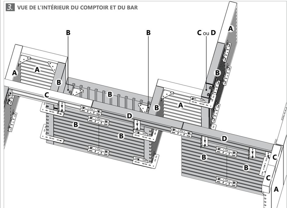
**IMPORTANT:** Il est recommandé de suivre les spécifications du fabricant du BBQ pour la ventilation et les dégagements. Permacon n'est pas responsable de la conformité des connexions, des dégagements et de la ventilation. Le BBQ, le comptoir et les accessoires ne sont pas inclus.
