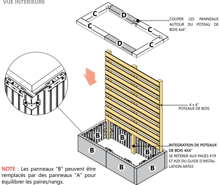
**NOTE :** Les panneaux "B" peuvent être remplacés par des panneaux "A" pour équilibrer les paires/rangs.
