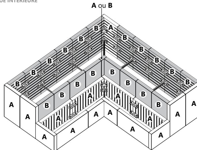
**NOTE :** Les panneaux "B" peuvent être remplacés par des panneaux "A" pour équilibrer les paires/rangs. Les panneaux "A" ne peuvent pas être remplacés par les panneaux "B".
