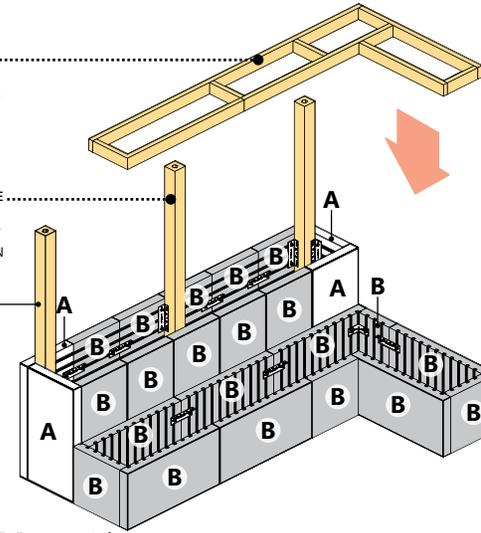
**NOTE :** Les panneaux "B" peuvent être remplacés par des panneaux "A" pour équilibrer les paires/rangs. Les panneaux "A" ne peuvent pas être remplacés par les panneaux "B".
