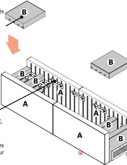
Le brûleur de 17x46" se dépose directement sur la quincaillerie ARTEX, sur les PLAQUES DE JONCTION
