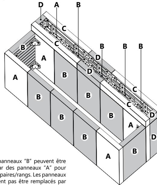
**NOTE :** Les panneaux "B" peuvent être remplacés par des panneaux "A" pour équilibrer les paires/rangs. Les panneaux "A" ne peuvent pas être remplacés par les panneaux "B".
