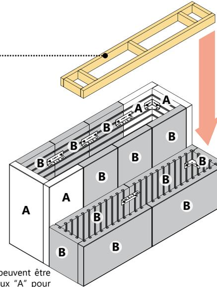
**NOTE :** Les panneaux "B" peuvent être remplacés par des panneaux "A" pour équilibrer les paires/rangs. Les panneaux "A" ne peuvent pas être remplacés par les panneaux "B".
