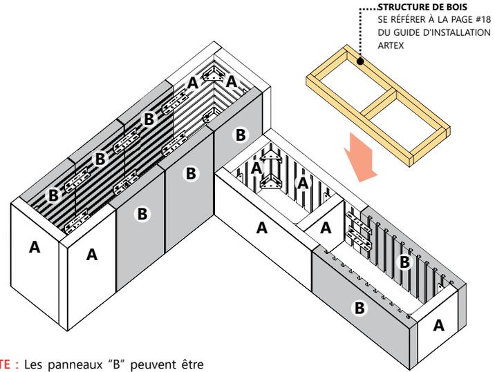
**NOTE :** Les panneaux "B" peuvent être remplacés par des panneaux "A" pour équilibrer les paires/rangs. Les panneaux "A" ne peuvent pas être remplacés par les panneaux "B".
