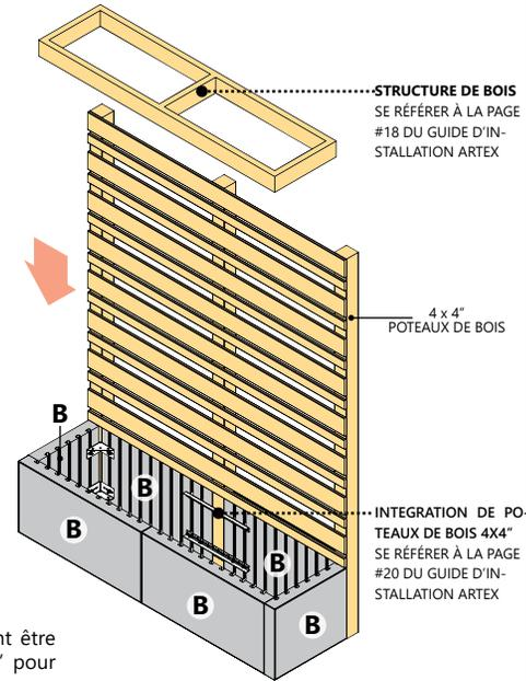
**NOTE :** Les panneaux "B" peuvent être remplacés par des panneaux "A" pour équilibrer les paires/rangs.
