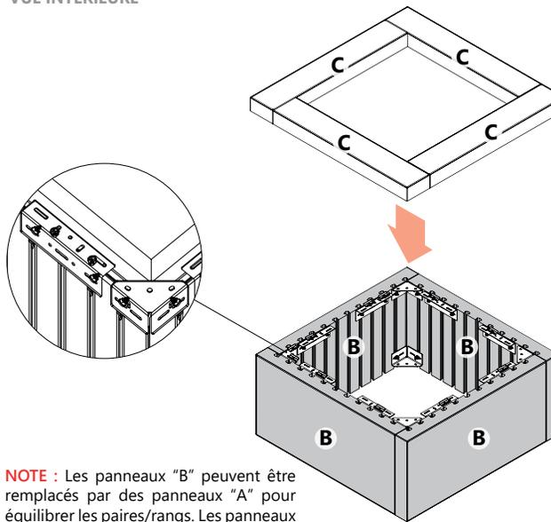
**NOTE :** Les panneaux "B" peuvent être remplacés par des panneaux "A" pour équilibrer les paires/rangs. Les panneaux "A" ne peuvent pas être remplacés par les panneaux "B".
