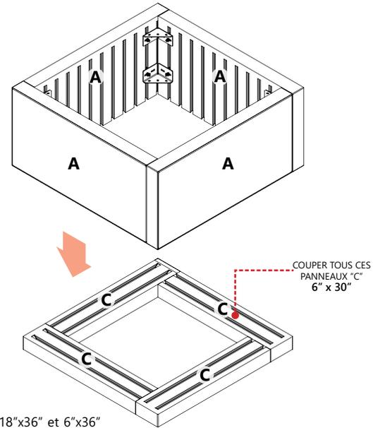
**NOTE :** Les panneaux 18"x36" et 6"x36" sont collés avec un ADHÉSIF À BÉTON
