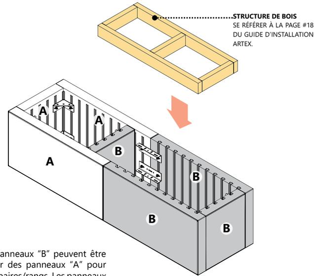
**NOTE :** Les panneaux "B" peuvent être remplacés par des panneaux "A" pour équilibrer les paires/rangs. Les panneaux "A" ne peuvent pas être remplacés par les panneaux "B".
